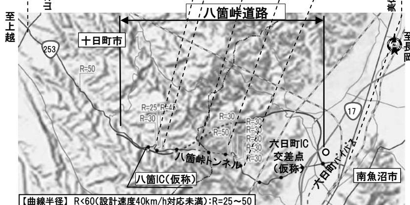
図 国道253号の線形不良区間
